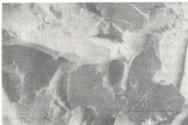
Rys. 20. Wyżarzanie zupełne 1250°C/1h. Przełom transkryystaliczny żupliwy o wyraźnie zaznaczonych płaszczyznach rozdziału
