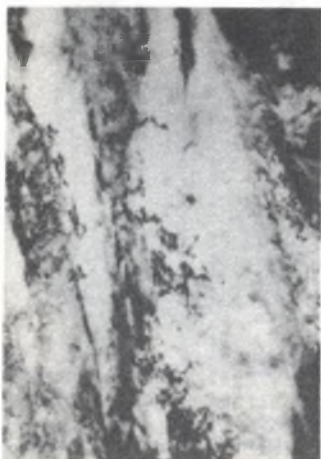
Rys. 17. Struktura po hartowaniu z 950^{\circ}\text{C}/45 min., olej. Bainit o dużej gęstości dyslokacji zawierający drobne wydzielania węglików; cienka folia 40000x
