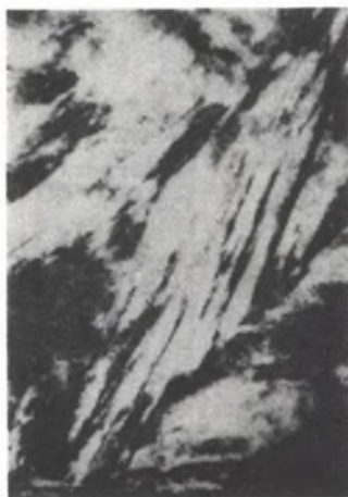
Rys. 14. Struktura po hartowaniu z 1000°C/45 min., woda Martenzyt o dużej gęstości dyslokacji częściowo zbliźniakowany: cienka folia, 40000x
