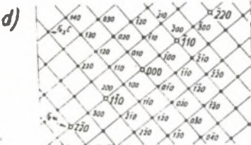
Rys. 15c,d. Obraz dyfrakcyjny szeregów struktury przedstawionego na rys. 15b oraz jego identyfikacja. [112]_{\alpha} \parallel [001]_{Me_3C}
