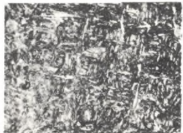
Rys. 11. Struktura gruboiglastego martenzytu azotowego. Azotowanie 950^{\circ}\text{C}/15\text{h} - woda. Pow. 400x
