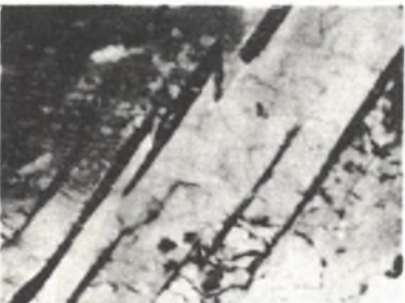
Rys. 16. Równoległe układy wydzieleni azotków \delta' w obszarach martenzytu o niewielkim stopniu zdefektowania. Azotowanie 950^{\circ}\text{C}/15\text{h} - woda oraz odpuszczanie 450^{\circ}\text{C}/15' . Pow. 65000\times
