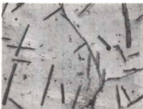
Rys. 5. Struktura ferrytyczna z licznymi wydzieleniami azotków żelaza w osnowie i po granicach ziarn ferrytu. Próbką po azotowaniu przy temperaturze 950^{\circ}\text{C}/15\text{h} - powietrze. Pow. 400x
