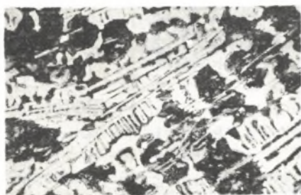
Rys. 7. Struktura żeliwa wyjściowego o zawartości 2,8% Si: ledeburyt, perlit, cementyt; Pow. 400x. Traw. MiFe
