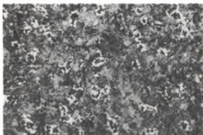
Rys. 9. Struktura żeliwa o zawartości 1,2% Si po 4 godzinach wyżarzania; perlit, ferryt, węgiel żarzenia; pow. 100x. Traw. Mi1Fe
