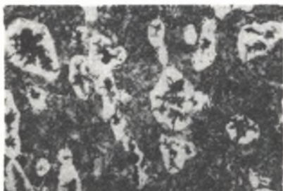
Rys. 11. Struktura żeliwa o zawartości 2,8% Si po 1 godzinie wyżarzania; perlit, ferryt, węgiel żarzenia; pow. 100. Traw. Mi1Fe
