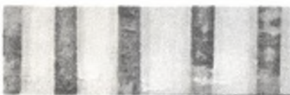
Rys. 19. Wygląd próbek z żelaza "Armco" aluminiowanych w kąpielu 99,99% Al po procesie wyżarzania w temp. 1000°C przez 24 cykle
