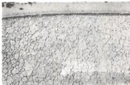
Rys. 21. Powłoka aluminiowa na stali H25N20S2 uzyskana w kąpielu 99,99%Al w czasie 1 min. po wyżarzaniu w temp. 1000°C przez 24 cykle. Traw. elektrolityczne. Pow. 100x
