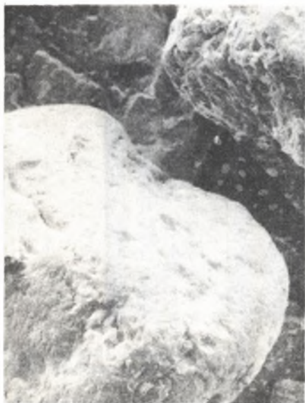
Rys. 12. Powierzchnia ziaren piasku kwarcowego, skaning 300x
