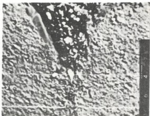
Rys. 9. Zmiana zawartości glinu wzdłuż stałej linii cięcia; 25 kV, 600 x
