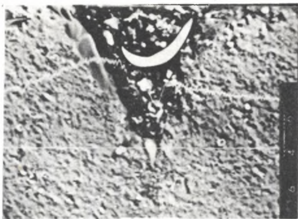
Rys. 11. Zmiana zawartości krzemu wzdłuż stałej linii cięcia; 25 kV, 600x
