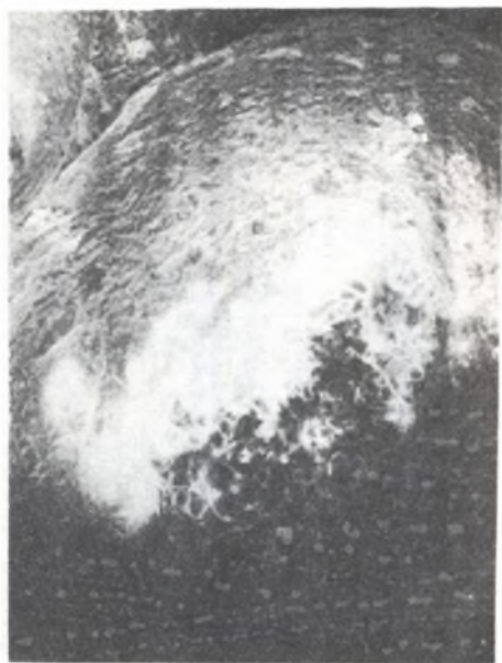
Rys. 18. Przekłom szyjki spoiwa fosforanowego nagrzanego do temperatury 865°C; skaning 10 kV, 300x
