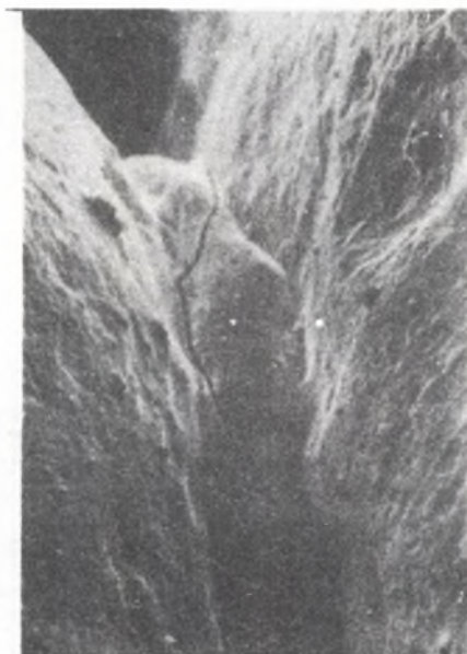
Rys. 17. Szyjka spoiwa fosforanowego nagrzana do temperatury 555°C; skaning 10 kV, 1000x
