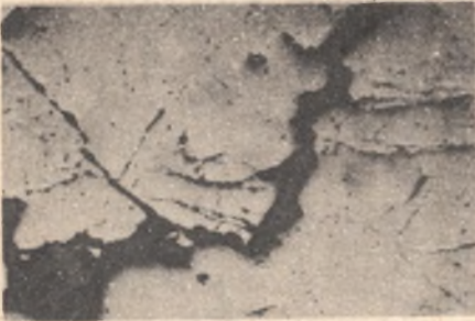
Rys. 3. Granica dwóch ziarn spineli chromowych rudy dońskiej wypełniona obficie lepiszczem żelazistym. Powierzchnia ziarn przy brzegach wyraźnie spękana (czarne linie). Światło odbite. Powiększenie 68 x
