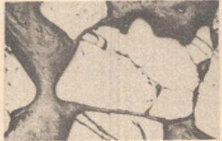
Rys. 5. Wyraźna szeroka granica kilku drobnych ziarn spineli chromowych rudy albańskiej obficie wypełniona lepiszczem. Powierzchnia ziarn wyraźnie spękana Światło odbite. Powiększenie 68 x
