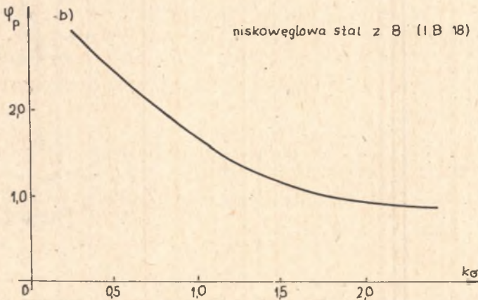
Rys. 8. Znalezione doświadczalnie krzywe odkształcalności granicznej a) dla M1E, EO4 i OH18N9 (wg Grosmana [2]), b) dla walcówki w stanie surowym, stal niskowęglowa z borem (wg Grosmana i Łukowskiego [3])
