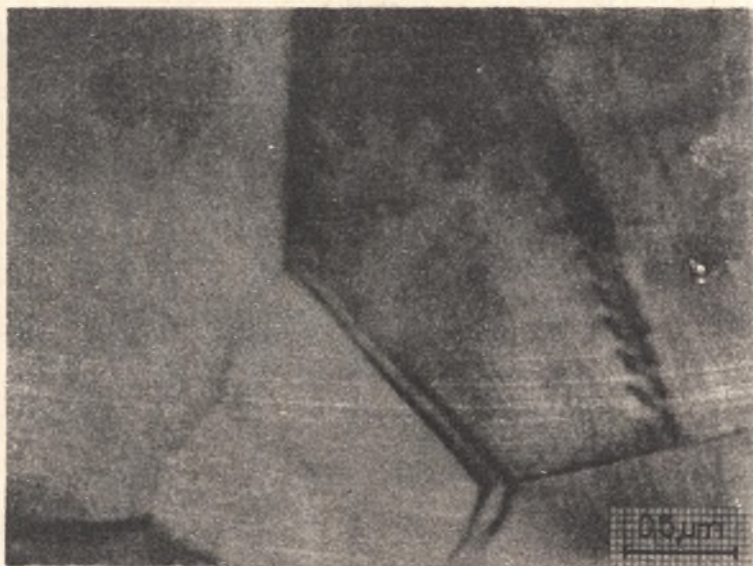
Rys. 9. Struktura wanadowanej powłoki dyfuzyjnej wytworzonej na stali NC6 o strukturze wyjściowej perlitu. Cienka folia
