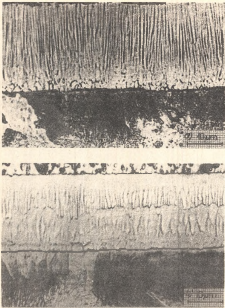
Rys. 3. Struktura chromowanej powłoki dyfuzyjnej wytworzonej na stali N9E o strukturze wyjściowej perlitu
