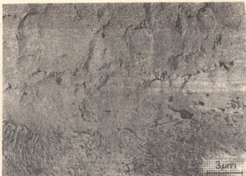
Rys. 8. Struktura wanadowanej powłoki dyfuzyjnej wytworzonej na stali N9E o strukturze wyjściowej perlitu. Replika matrycowa
