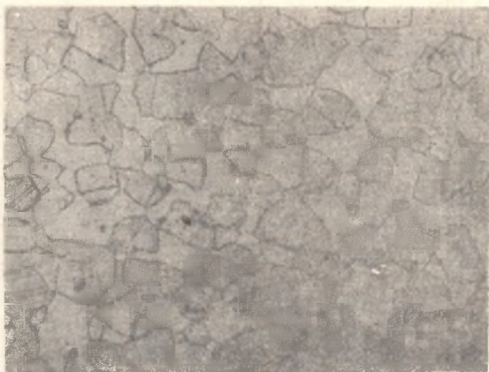
Rys. 7. Struktura ferrytyczno-austenityczna z wydzieleniami
