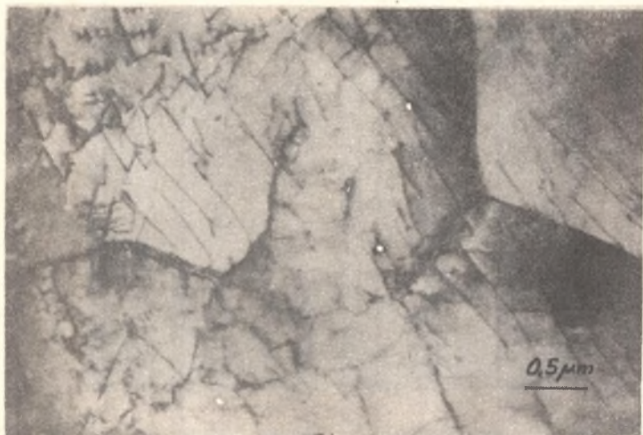
Rys. 12. Struktura po gorącym walcowaniu. Ferryt z niskokątowymi granicami ziaren. W osnowie widoczne liniowe dyslokacje tworzące miejscami układ komórkowy
