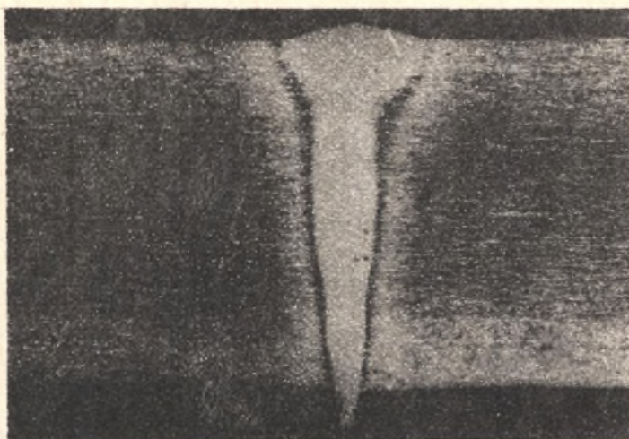
Rys. 8. Makrostruktura złącza spawanego wiązką elektronów ze stali 50H17G17
