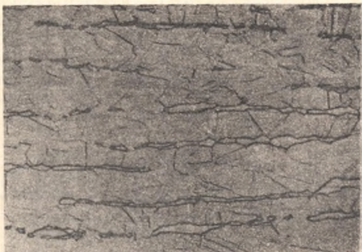
Rys. 6. Mikrostruktura stali 60G30J9. Pow. 250x
