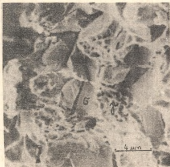
Rys. 13. Stal A po pełzaniu 650°C (59 MPa) 17738 h. Kruche pęknięcia fazy sigma otoczone ciągłymi obazarami odpowiadającymi austenitowi
