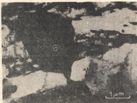
Rys. 12. Szczegół struktury stali A po pełzaniu 600°C (84 MPa) 15412 h, przedstawiający rozpad \alpha_M \rightarrow M_{23}C_6 + G + \gamma_2 . Cienka folia
