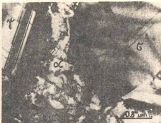
Rys. 11. Szczegół struktury stali B po pełzaniu 650°C (84 MPa) 19168 h. Cienka folia
