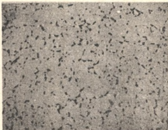
Rys. 14. Struktura austenitowo-ferrytyczna stali C po stopniowym przesycaniu 1270°C (960°C) woda. Pow. 160 c
