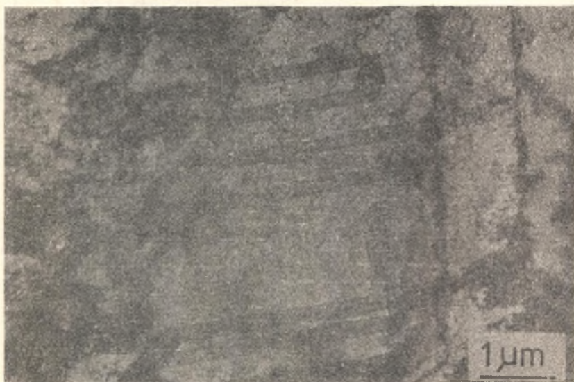
Rys. 8. Odształocenie 5%. W obszarze o małej gęstości dyslokacji widoczne błędy ułożenia
