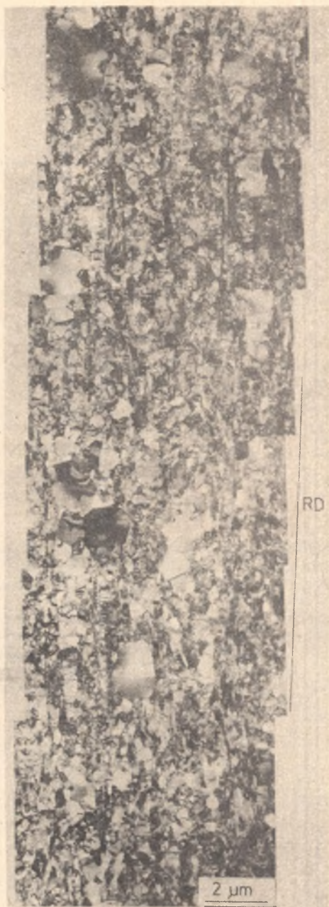
Rys. 14. Odkształcenie 87%. Wyżarzanie przez 1 godz. przy temperaturze 400°C. Duża gęstość nowych ziarn
