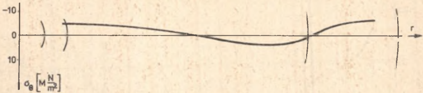
Rys. 3.13. Wykres uwolnionych naprężeń własnych z kół po odcięciu obrzeża
