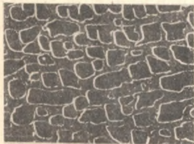
Rys. 5. Mikrostruktura stopu WT 3-1, mikroskop skaningowy, pow. 3000 x
