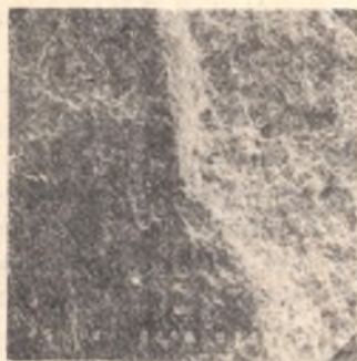
Rys. 7. Obraz przełomu uzyskany za pomocą sygnału elektronów wtórnych (stal 5). Pow. 100 x
