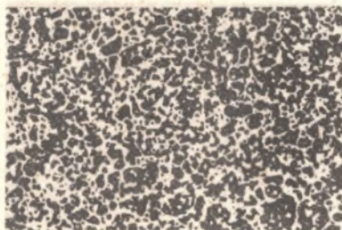
Rys. 9. Drobnoziarnista struktura austenitu pierwotnego stali konwencjonalnej po próbie skręcania w temperaturze 1100^{\circ}C , 1000 x
