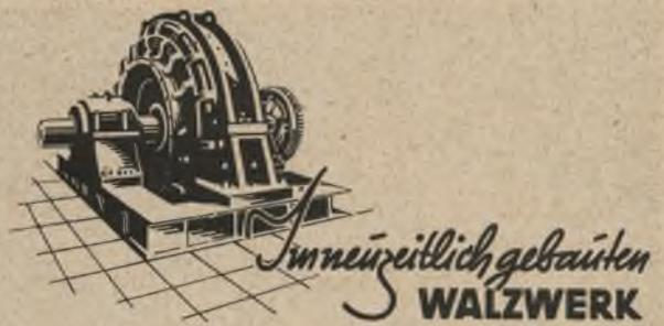
werden Blockstraßen durch Umkehr-Walzmotoren angetrieben, die durch Stromrichter gespeist werden. Ihre Betriebssicherheit haben derartige Antriebe seit 1937 unter Beweis gestellt.
