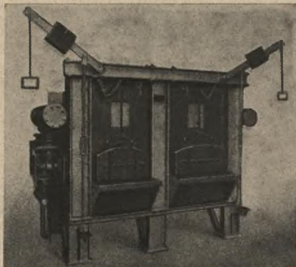
Gasbeheizter Doppelkammer-Schmiedeofen mit eingebautem Stahlrekuperator
