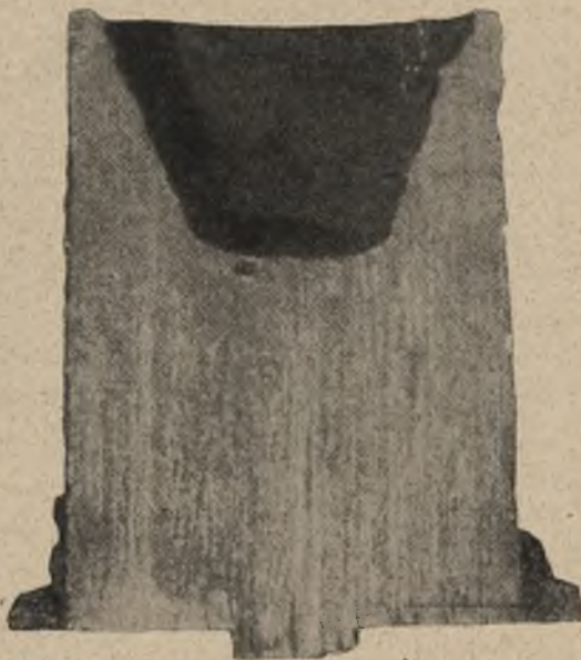
Mit Bruinella „Apece B“ behandelter Kopf eines im Gespann gegossenen 1-t-Blocks.
