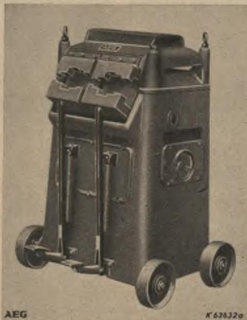
Die Einspannelektroden sind schräg gestellt und erleichtern durch diese bequeme Anordnung die Beschickung. Auch läßt sich dadurch der Erwärmungsvorgang leichter überwachen. Durch Federspannung klemmen sie die eingespannten Niete fest, wobei eine Aenderung der Elektrodenfederspannung bei wechselnden Nietlängen nicht nötig ist.
