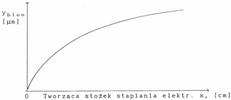
Rys.3. Kształt powierzchni ciekłej fazy metalu na tworzącej stożek stapiania elektrody
