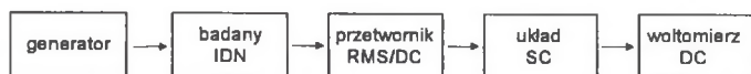
Rys.2. Schemat blokowy układu do wzorcowania indukcyjnych dzielników napięcia wykorzystującego ideę przełączalnych kondensatorów
