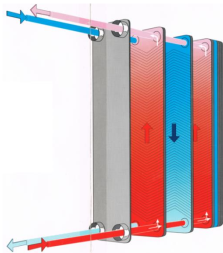
Rysunek 2.4 – schemat budowy wymiennika ciepła. Źródło: materiały promocyjne Tau Energy Products, Szwecja.
