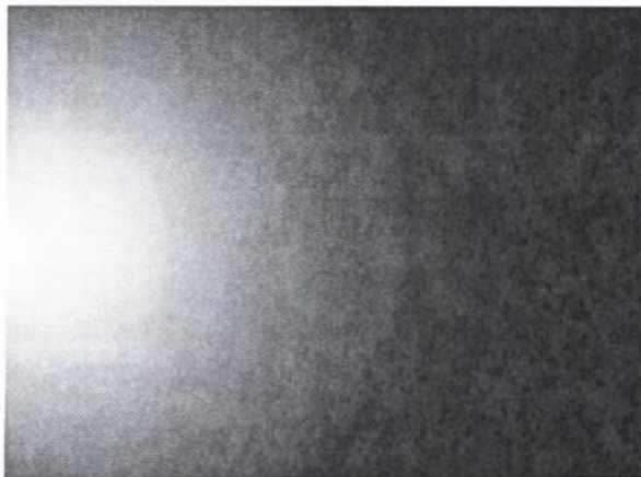
Rys. 2. Fotografia płaszczyzny oświetlonej punktowym źródłem światła Fig. 2. Picture of surface with spotlight light source
