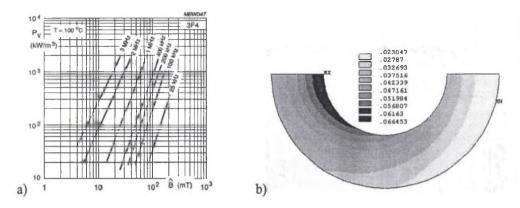
Fig. 3. The specific power losses (a) and distribution of flux density (b) in the magnetic core Rys. 3. Jednostkowe straty mocy (a) oraz rozkład indukcji magnetycznej (b) w rdzeniu
