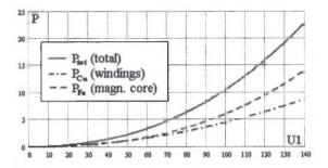
Fig. 4. The power losses in the basic transformer (BT) versus input voltage (rms value) Rys. 4. Zależność strat mocy w transformatorze (BT) od napięcia zasilającego (rms)
