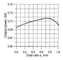
Fig. 8. Output power versus oval rate in OCT transformer Rys. 8. Moc wyjściowa transformatora jako funkcja współczynnika owalności *a*
