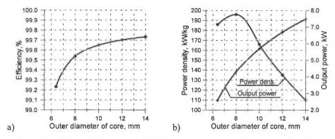
Fig. 6. The efficiency (a) and power (b) of the transformer vs outer diam.  $d_c$  of magnetic core Rys. 6. Sprawność (a) i moc transformatora (b) jako funkcja średnicy  $d_c$  rdzenia
