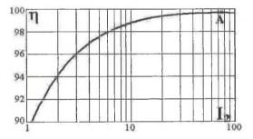
Fig. 5. The efficiency versus output current (BT) Rys. 5. Sprawność transformatora (BT) w funkcji prądu wyjściowego
