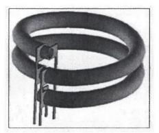
Fig. 1. Windings of the basic transformer (BT) (without magnetic core) Rys. 1. Uzwojenia konstrukcji bazowej transformatora (bez rdzenia)
