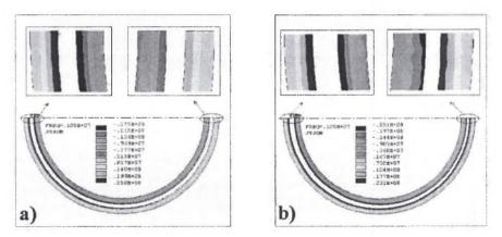
Fig. 9. The distribution of the current in the windings of (a) BT and (b) NCT arrangement Rys. 9. Rozkład prądu w uzwojeniach transformatora o konstrukcji (a) BT (b) NCT
