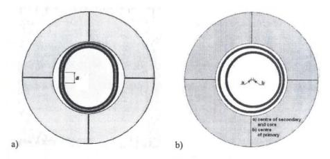
Fig. 7. The cross section of transformer (a) oval concentric (OCT); (b) non-concentric (NCT) Rys. 7. Przekrój transformatora a) koncentrycznego owalnego oraz b) niekoncentrycznego
