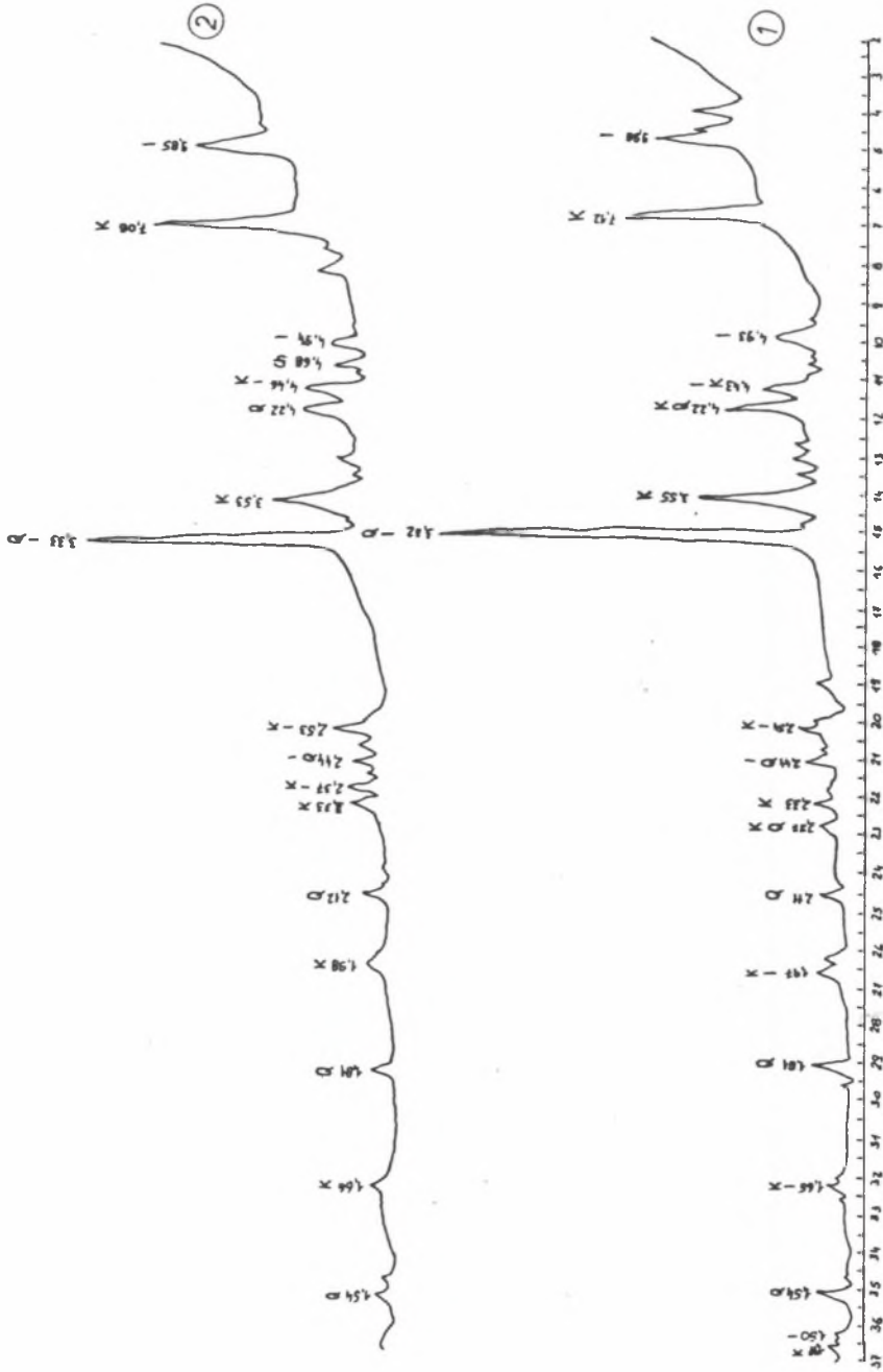
Rys. 4. Rentgenogramy przerostów ilastych. Objasnienia znakow: K - kaolinit, Ch - chloryt, Q - kwarc, I - illit, S - syderyt, P - piryt, M - muskowit
