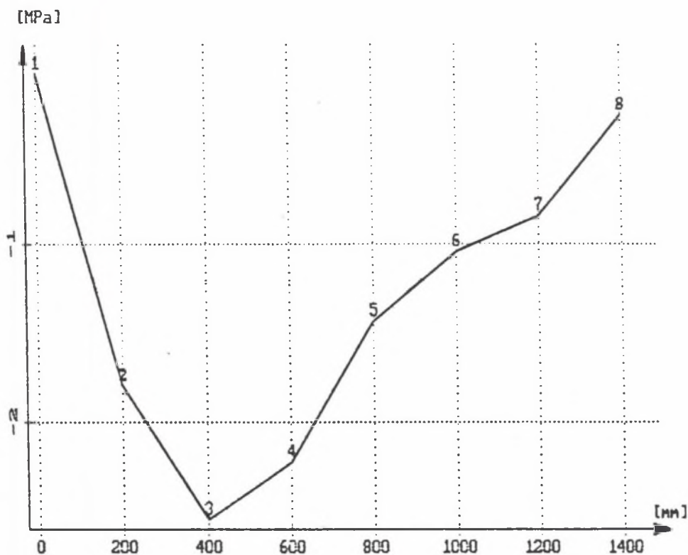
Rys. 4. Rozkład nacisków pomiędzy stropnicą a stropem Fig. 4. A unit pressure distribution between a roof and a canopy
