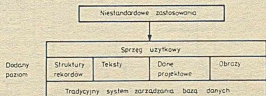
Rys. 1. Architektura dodanego poziomu
