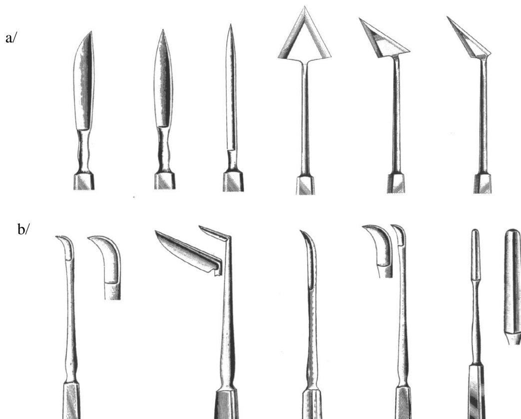
Rys. 5.10. Przykłady geometrii ostrzy nożyków [6]: a – do zabiegów na gałce ocznej, b – do zabiegów w obrębie gardła
