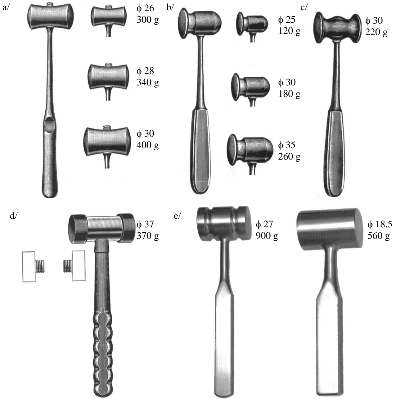
Rys. 5.108. Przykłady postaci konstrukcyjnych narzędzi uderzających [6, 11]: a – młotek typu Williger, b – młotek typu Doyen, c – młotek typu Collin, d – młotek typu Martin-Ferrozell, e – pobijaki ortopedyczne
