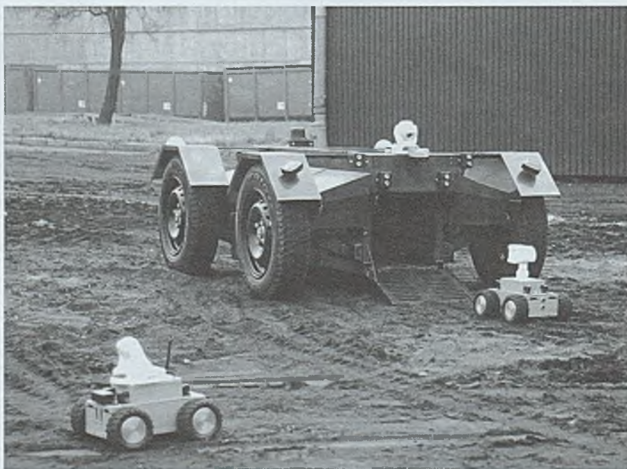
Grupa autonomicznych robotów mobilnych - autonomiczna jednostka centralna oraz autonomiczne roboty inspekcyjne - podczas inspekcji obiektu technicznego
