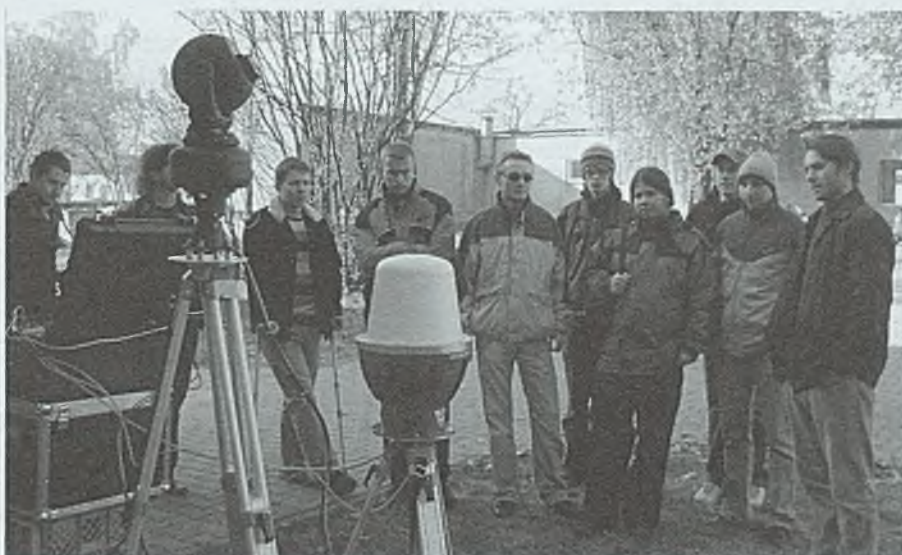
Radar Navtech sprzężony z kamerą wizyjną i termowizyjną
