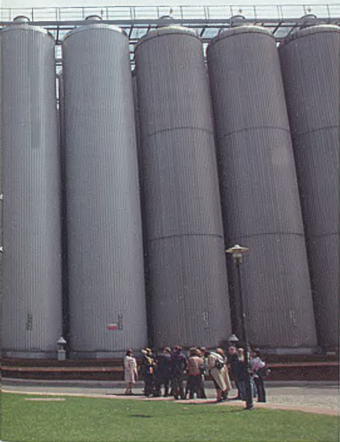
są olbrzymie, pionowe zbiorniki zwane tankofermentatorami. proces fermentacji piwa
