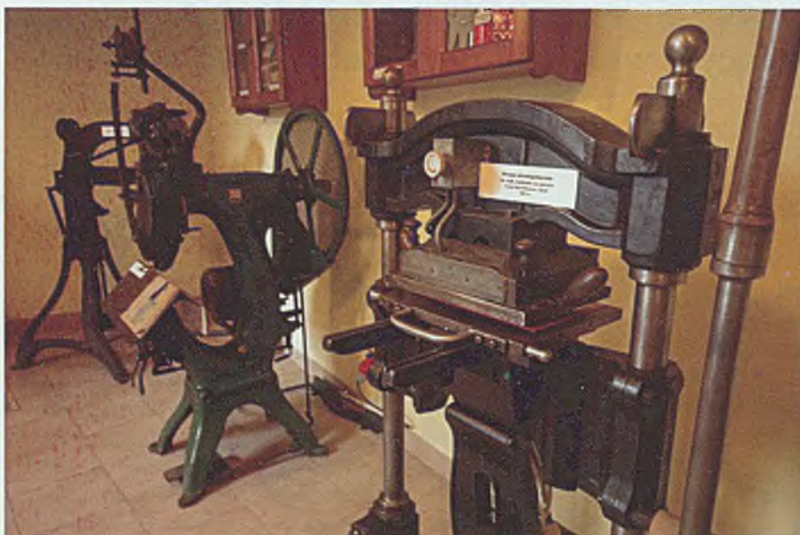
W pomieszczeniu introligatori można podziwiać m.in. XIX-wieczną prasę do wykonywania nadruku na gorąco
