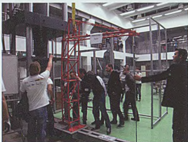
Konstrukcję żurawia wieżowego stanowią elementy misternie łączone w segmenty
