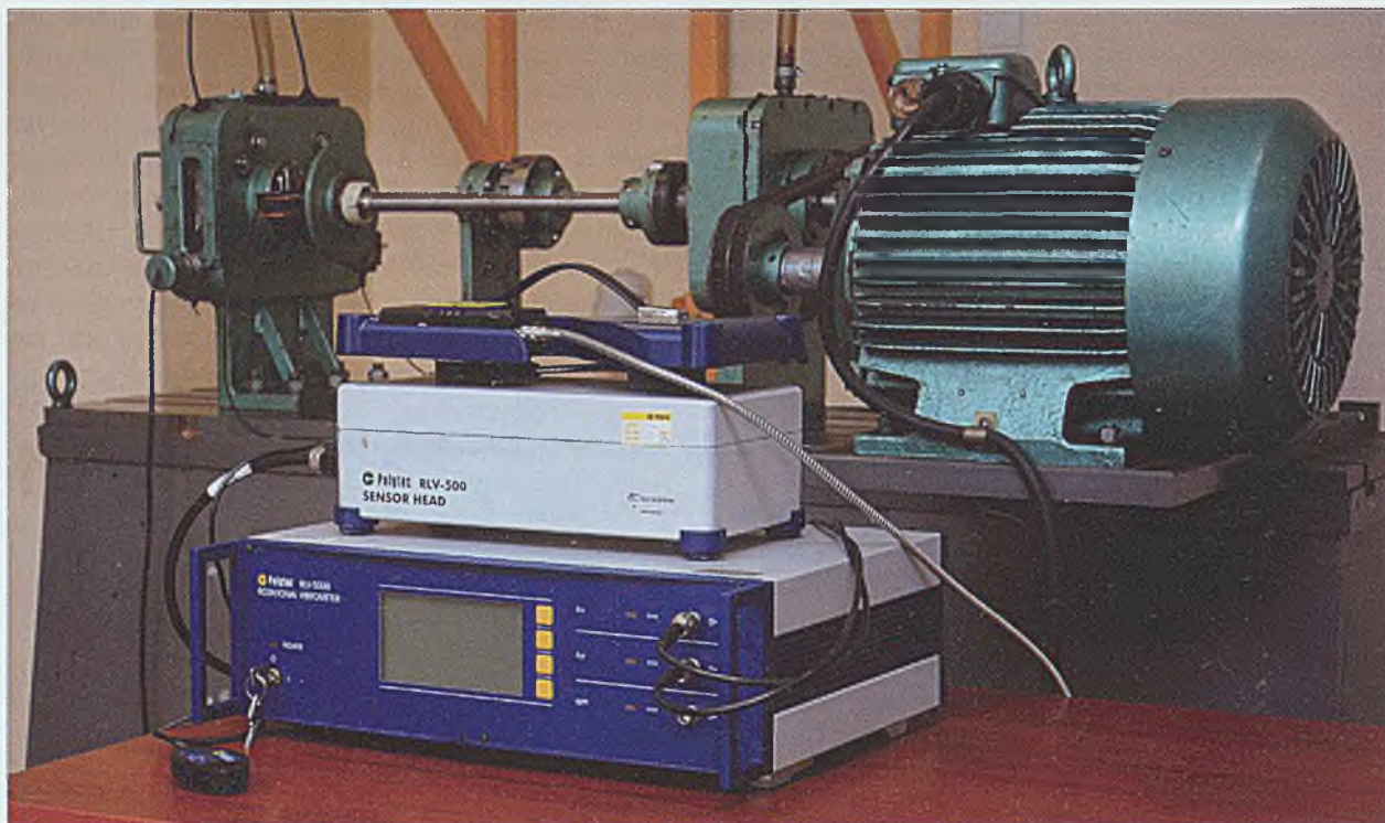
Wibrometr laserowy do pomiaru drgań skrętnych
