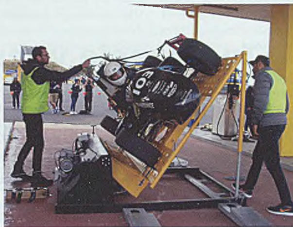
Chachor podczas testu pochyleniowego (tilt test)
