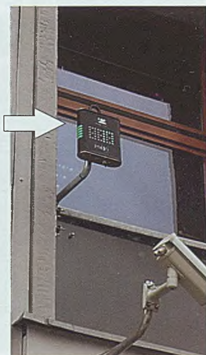
Czujnik smogu na budynku Wydziału Architektury oraz aplikacja na smartfona
