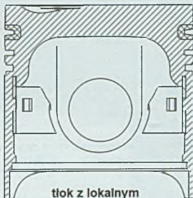
Koncepcja zastosowania wkładki kompozytowej w tłoku do silnika wysokoprężnego
