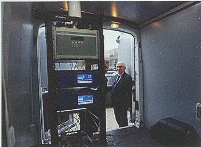
Wnętrze mobilnego laboratorium pomiarów emisji zanieczyszczeń powietrza
