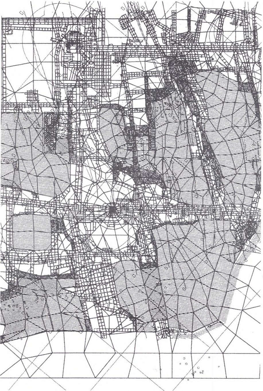
Rys. 2.23. Geometria wyrobisk w części obszaru górniczego Kopalni III z podziałem na elementy skończone Fig. 2.23. Mining geometry within the Mine III with finite elements approximation
