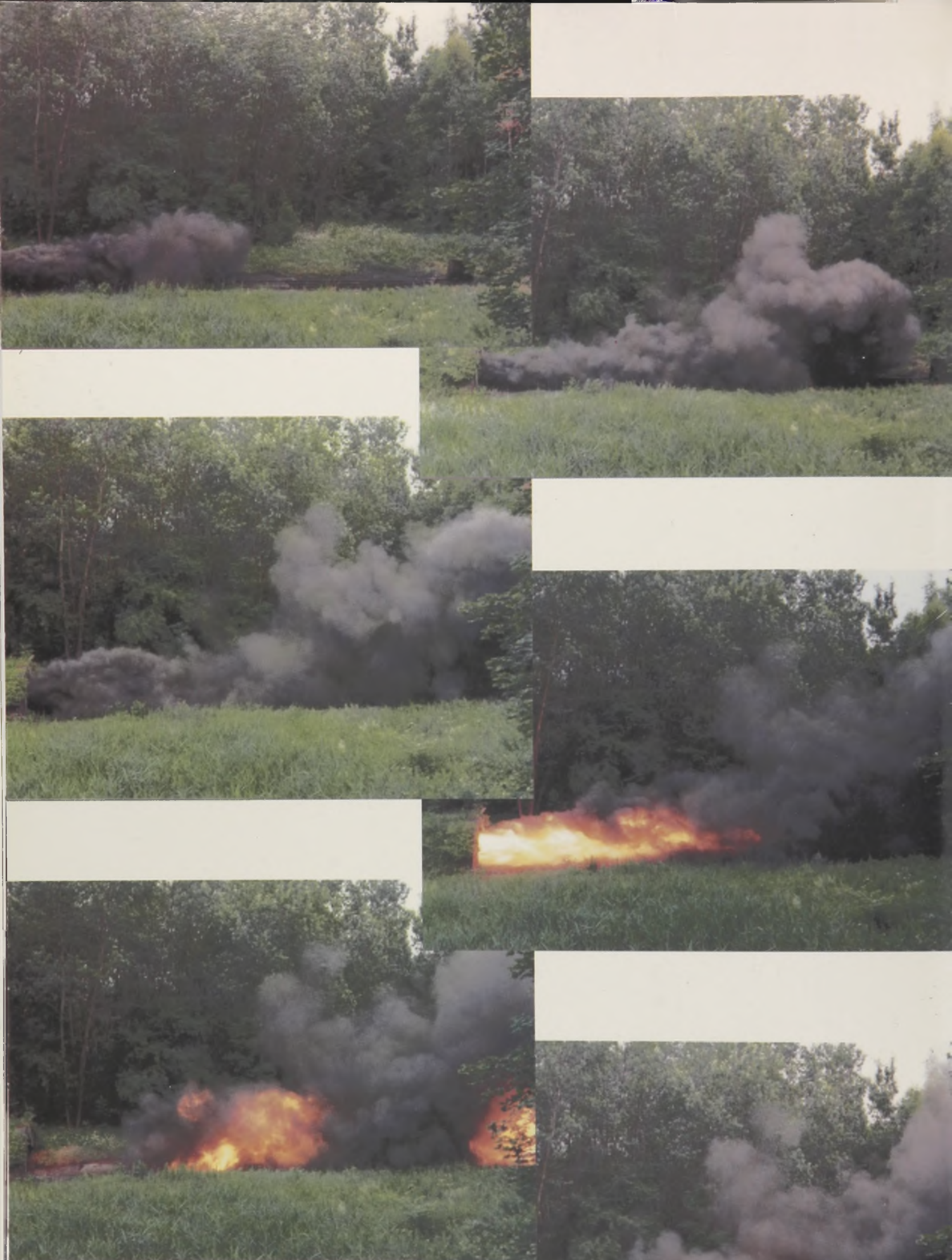
Wybuch pokazowy pyłu węglowego podczas konferencji COE'2000 W sztolni Kopalni Doświadczalnej „Barbara”
