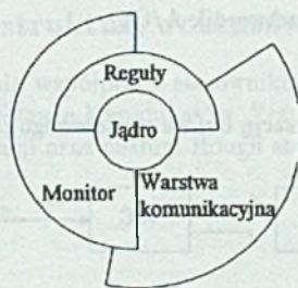
Rys. 3. Schemat systemu operacyjnego Rough sterownika
