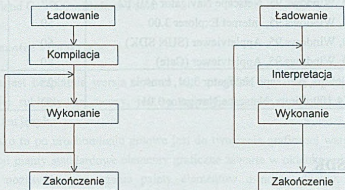
Rys. 1. Sposób wykonania programu z kompilatorem i bez niego Fig. 1. Program execution with and without compiler
