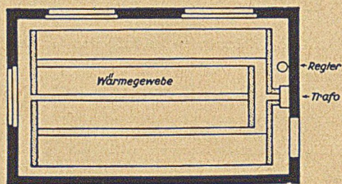
Bild 165. Grundriß einer elektrischen Fußbodenheizung nach Bild 164.
