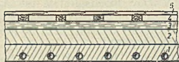
Bild 54. Schnitt durch eine mittels Heizröhren erwärmte Betondecke.
