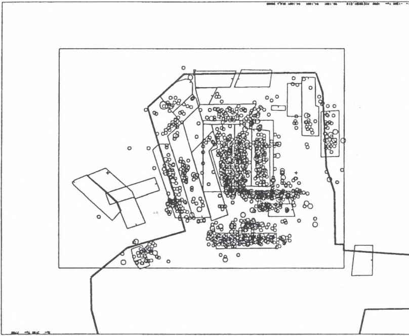
Rys.2. Rozmieszczenie ognisk wstrząsów o en. \geq 1 \times 10^4 J zarejestrowanych w rejonie ścian 7a, 4, 5 - pokł. 509 kop. Bobrek w okresie 90.10.01 - 94.10.01
