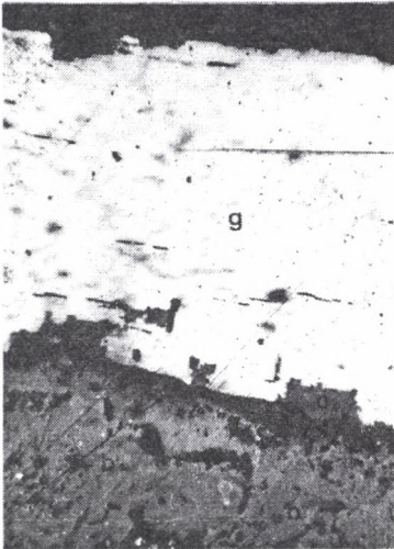
Fot.3. Cerusyt w szczelinach i na krawędziach ziarna galeny występującego w blendzie skorupowej. Kop. Olkusz, światło odbite, pow. 60x
