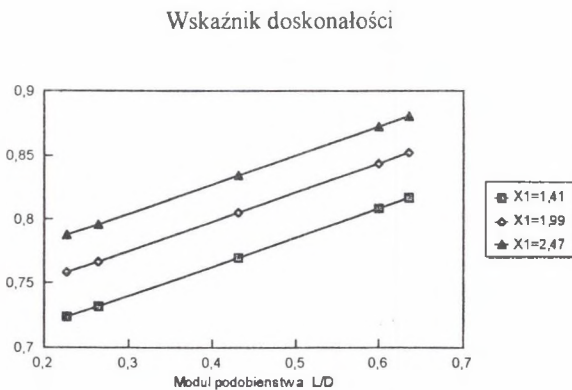
Rys.3. Wpływ proporcji wirnika na stopień doskonałości procesu \phi_3 = 10/100 Fig.3. Influence of rotor proportion on effect of classification \phi_3 = 10/100
