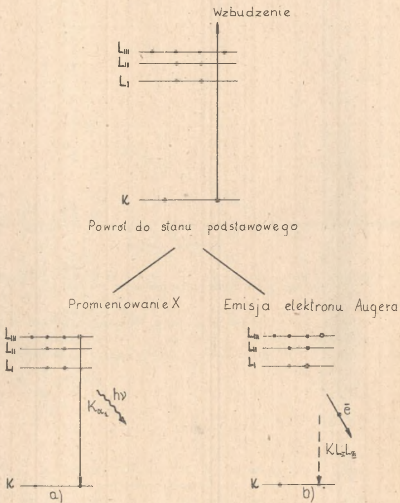
Rys. 1. Powrót atomu wzbudzonego do stanu podstawowego [13] a) emisja promieniowania X, b) emisja elektronu Augera
