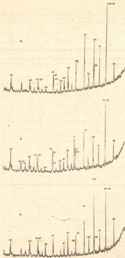
Rys. 3. Dyfraktoqramy stałego roztworu Ba(Ti_{0.98}Sn_{0.02})O_3 a) ceramika, b) warstwa niestekturowana, c) warstwa stekturowana
