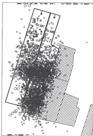
Rys. 1. Kontury eksploatacji w pokł. 703/1-2 z naniesionymi ogniskami wstrząsów Fig. 1. Mining contours in bed 703/1 with marked focuses of recorded tremors
