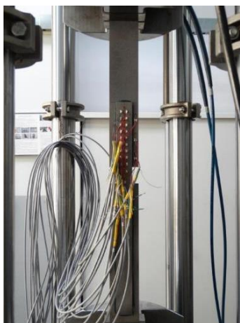
Rys. 69 Elementy przygotowane do badania: a) długość połączenia 400/200 mm; b) długość połączenia 400/400 mm [41]
