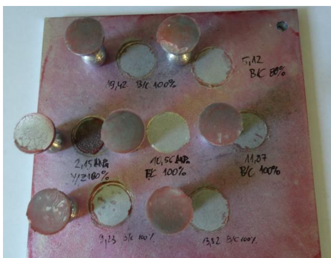
Rys. 41 Wyniki badania na podłożu ze stali ocynkowanej
