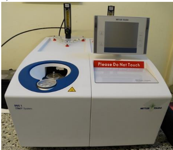
Rys. 51 Aparat DSC 1 firmy Mettler-Toledo wyposażony w intracooler Huber TC100 MT [8]
