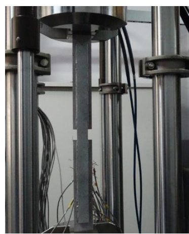
Rys. 69 Elementy przygotowane do badania: a) długość połączenia 400/200 mm; b) długość połączenia 400/400 mm [41]
