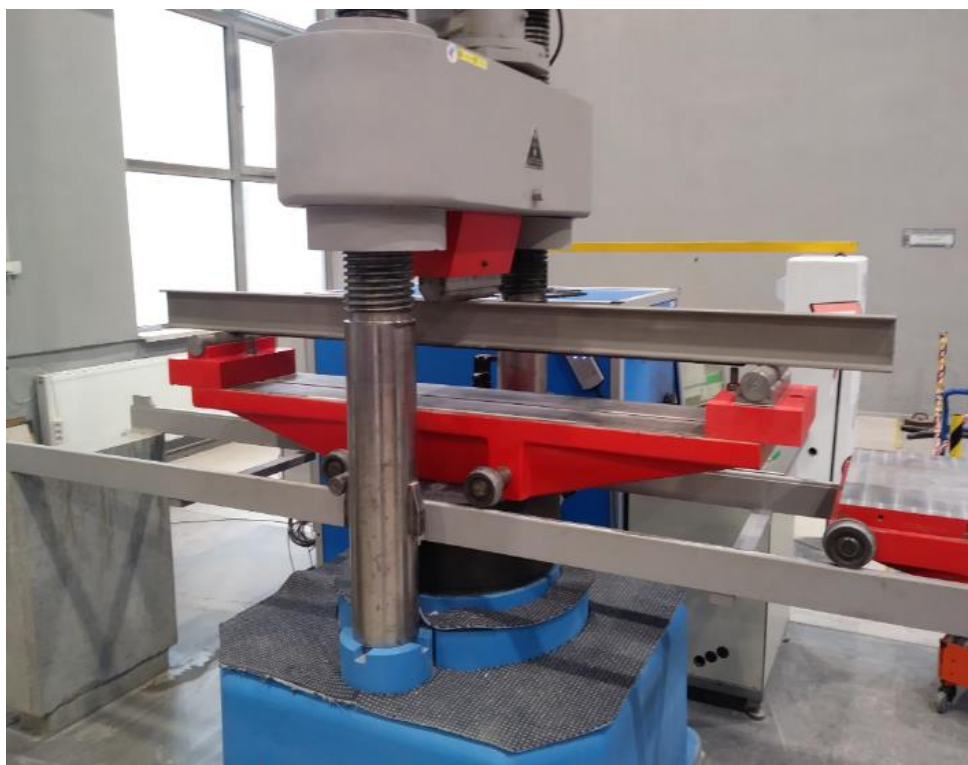
Rys. 78 Belka przygotowana do badania trójpunktowego zginania
