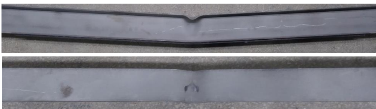
Rys. 83 Odkształcenia belki wzmocnionej (1A) po przeprowadzonym badaniu
