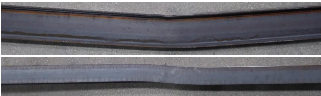
Rys. 82 Odkształcenia belki niewzmocnionej (0A) po przeprowadzonym badaniu
