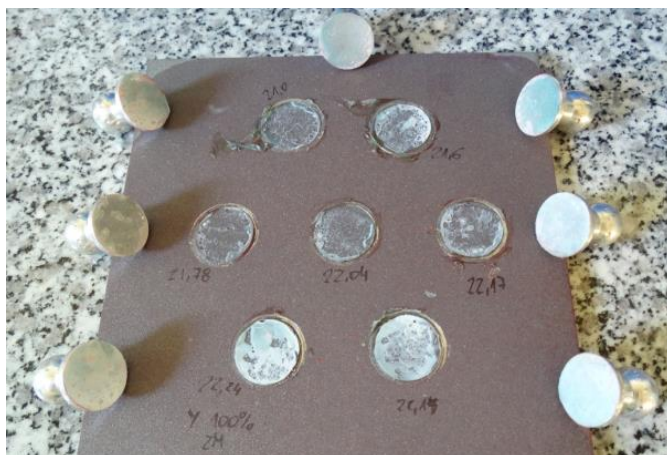
Rys. 40 Wyniki badań odrywania na podłożu ze stali piaskowanej
